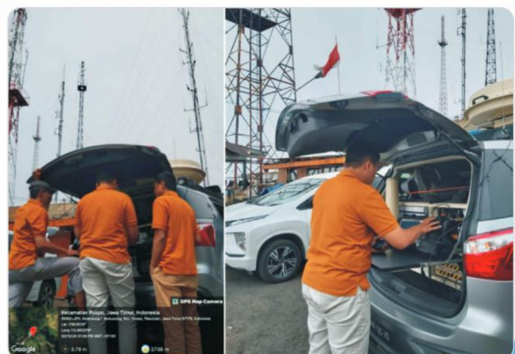
Gambar 14. Melakukan observasi, monitoring, pengukuran dalam rangka penanganan gangguan frekuensi radio 853.6625 MHz PT. PLN Unit Pelaksana Pengatur Distribusi (UP2D) Jatim di Penanjakan, Pasuruan.
