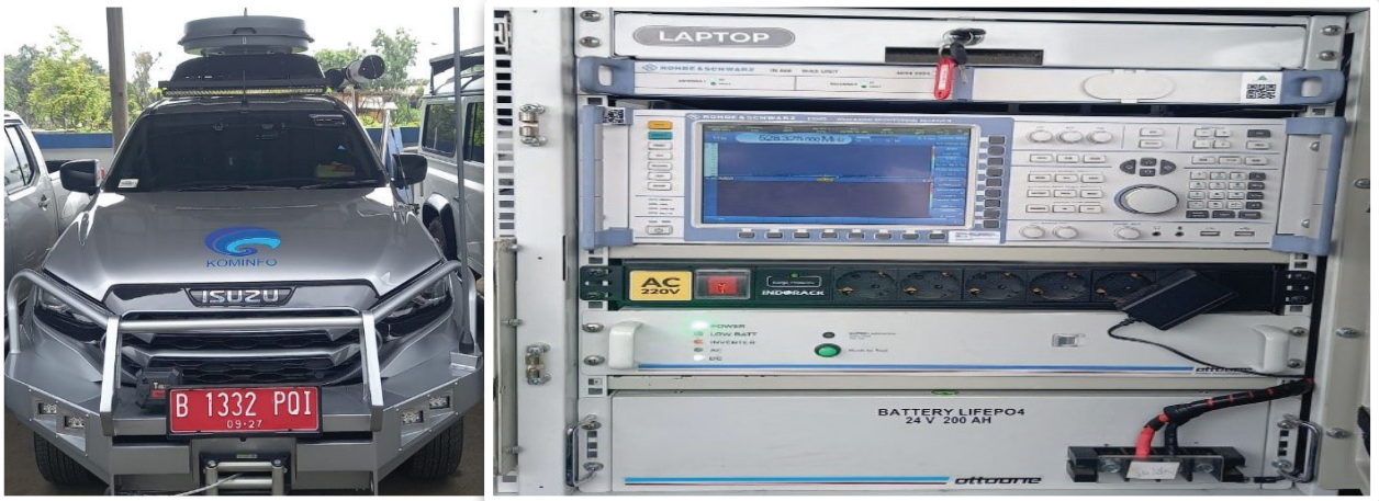
Stasiun Bergerak Mon/DF R&S ESMD (Mobil SUV Merk Isuzu tipe MUX)
