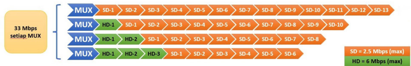
Gambar 4.11 Konfigurasi umum penggunaan slot multipleksing TV digital
