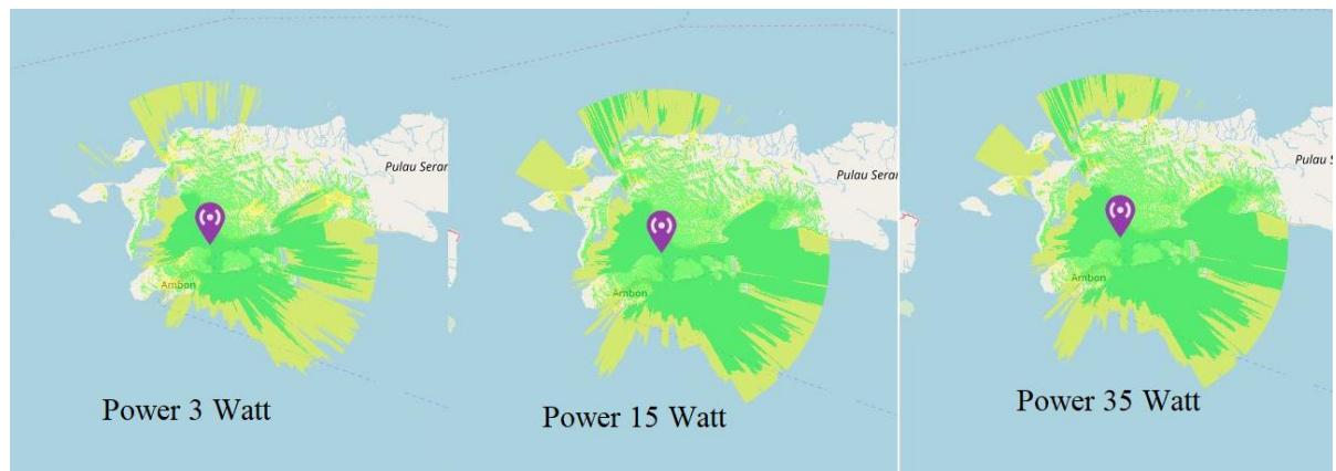
Gambar 2 Hasil Analisa Coverage Area dengan tinggi antenna 4,5 M dpt
