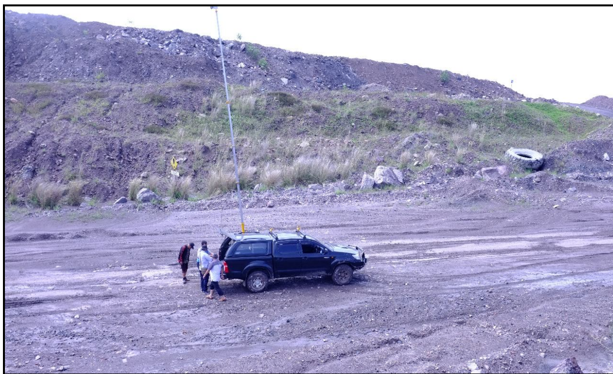
Kegiatan Pengukuran Kuat Medan Cakupan Wilayah Layanan Radio Siaran di Kab. Tanah Bumbu
